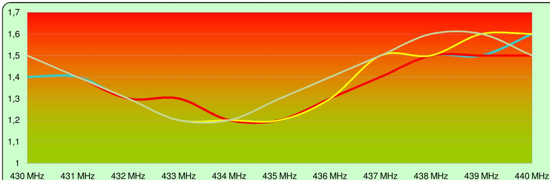
COZ s2 = Première réalisation tube cuivre 6,35mm corps de l'antenne en polyamide
